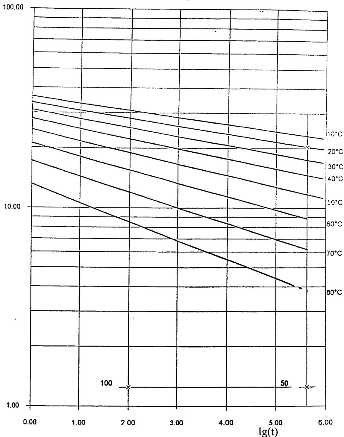
$$\lg(t) = -121,699 - (25985/T) \cdot \lg(\sigma) + 47143,18/T + 63,03511 \cdot \lg(\sigma),$$
