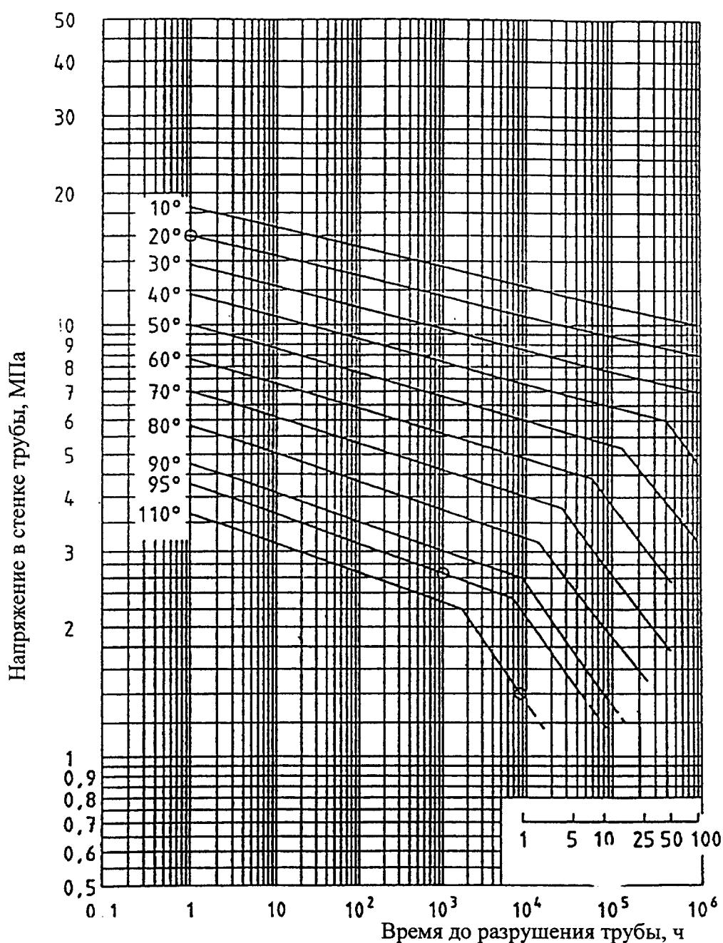
Левая часть ломаной:  $\lg(t) = -56,086 - (10157,8/T) \cdot \lg(\sigma) + 23971,7/T + 13,32 \cdot \lg(\sigma)$
