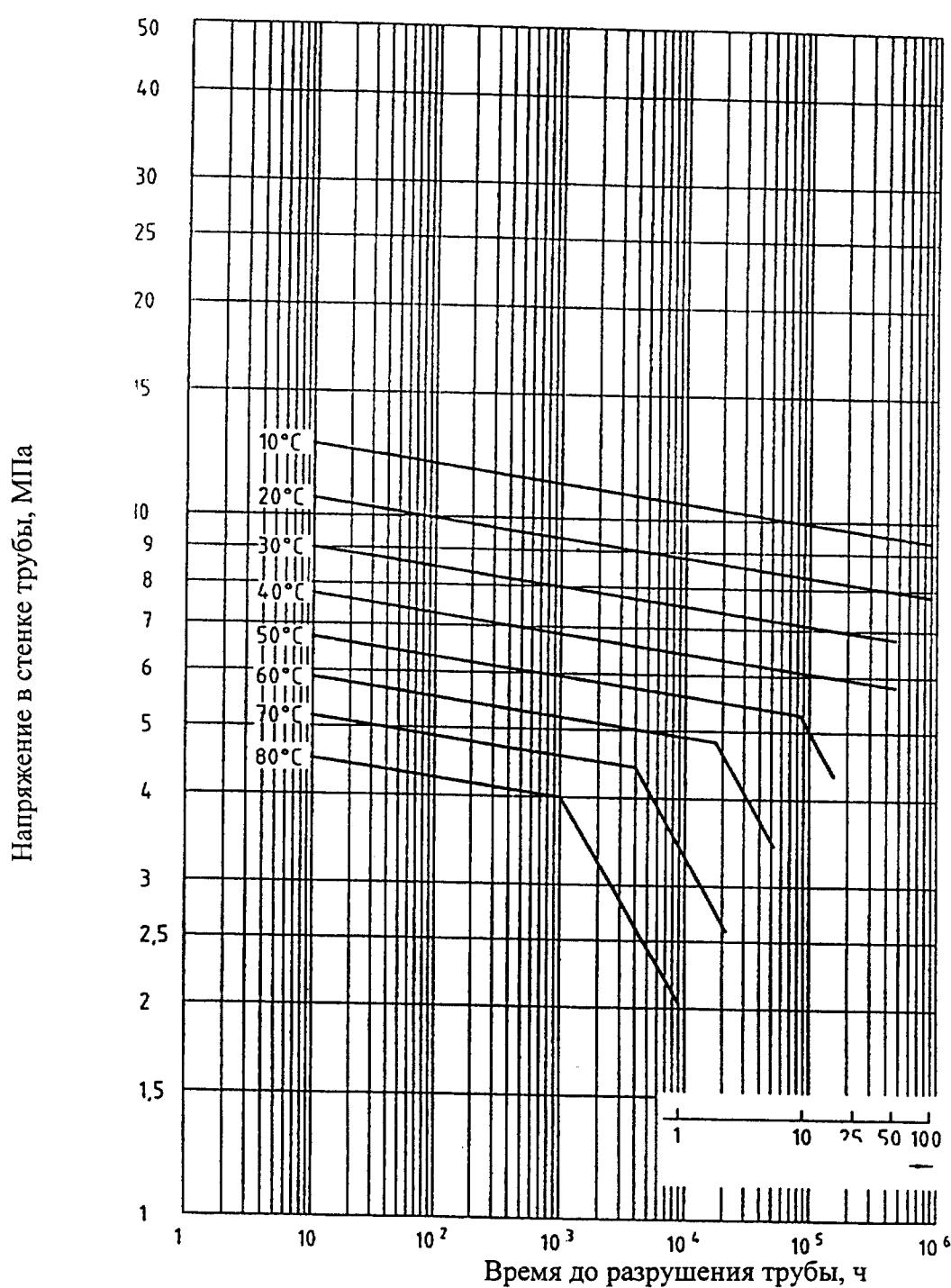
Левая часть ломаной:  $\lg(t) = -40,9578 + 23596,3495/T - 37,5758 \cdot \lg(\sigma)$
