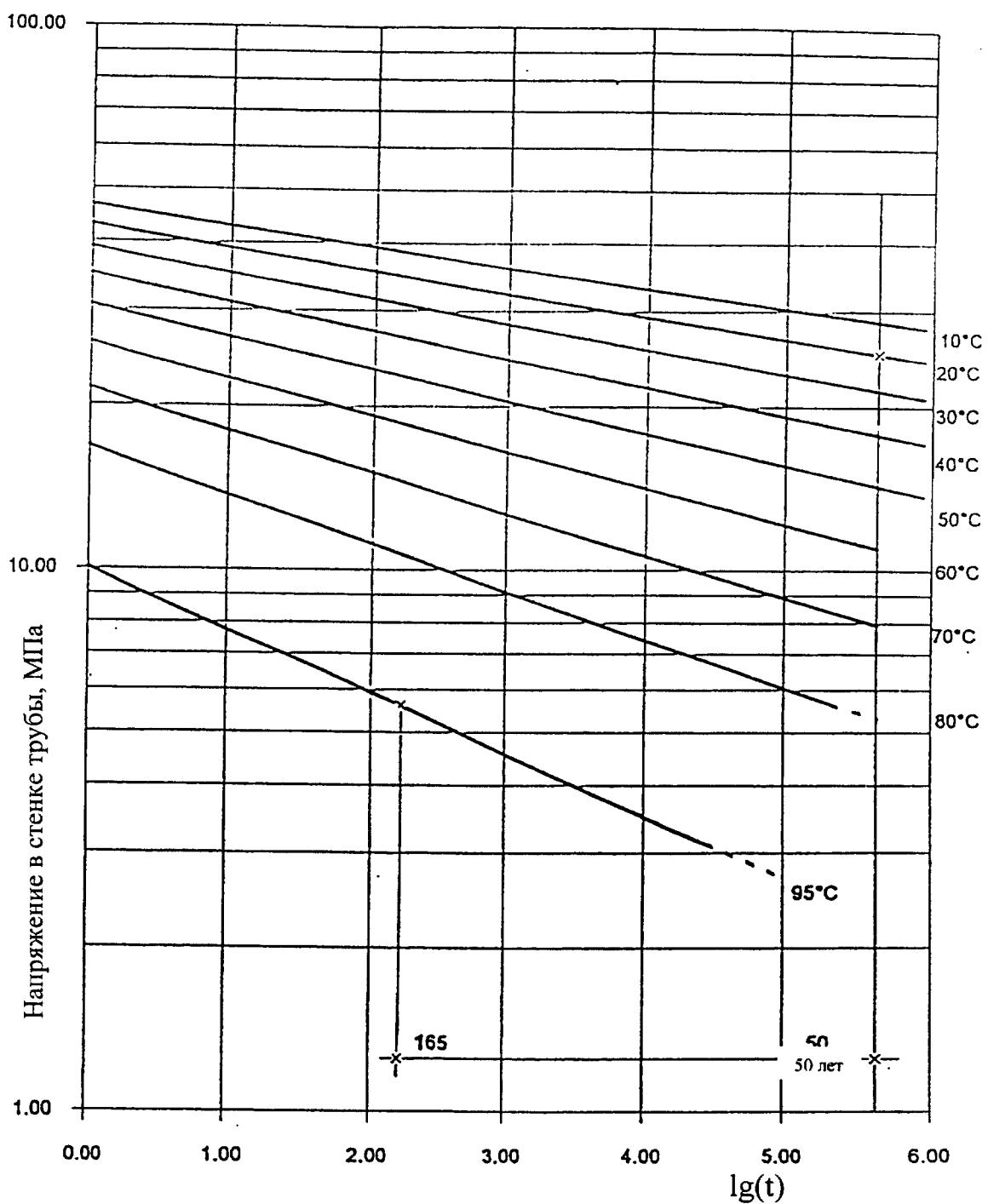
$$\lg(t) = -109,95 - (21897,4/T) \cdot \lg(\sigma) + 43702,87/T + 50,74202 \cdot \lg(\sigma),$$
