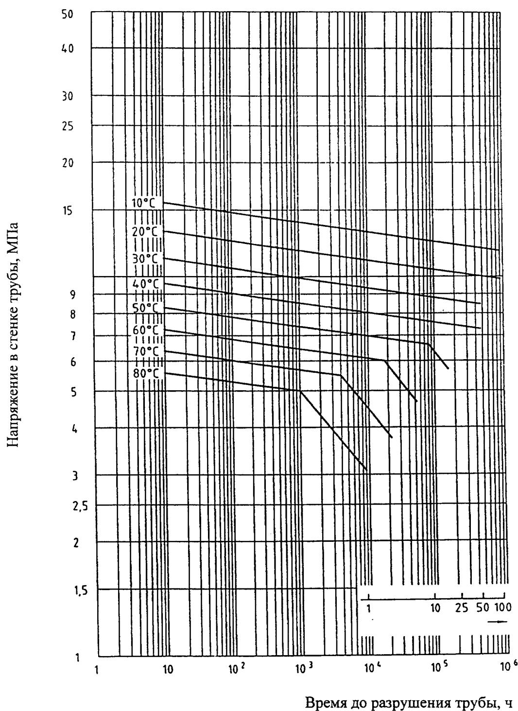
Левая часть ломаной:  $\lg(t) = -38,9375 + 24482,4670/T - 38,9789 \cdot \lg(\sigma)$
