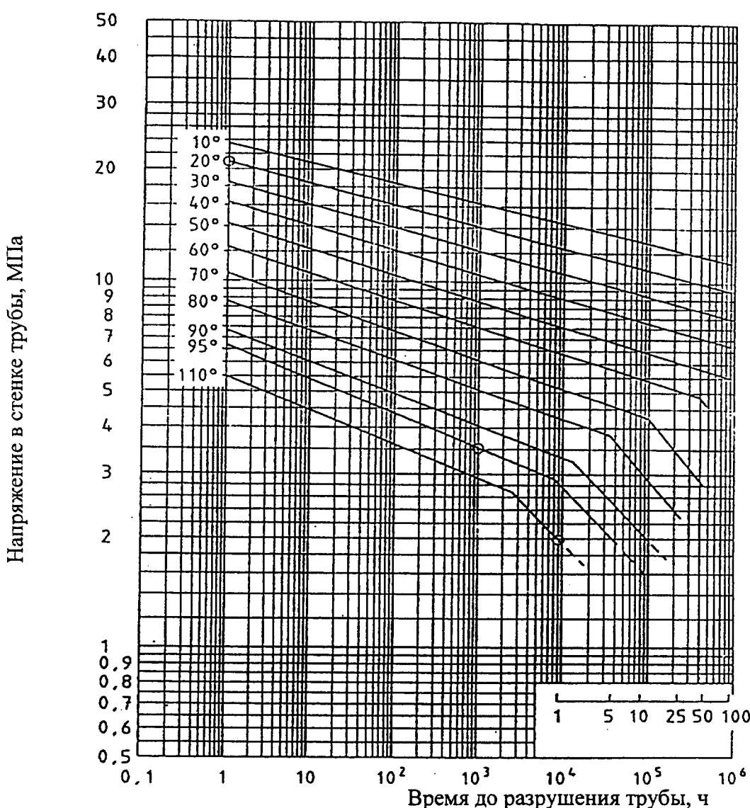
Левая часть ломаной:  $\lg(t) = -46,364 - (9601,1/T) \cdot \lg(\sigma) + 20381,5/T + 15,24 \cdot \lg(\sigma)$
