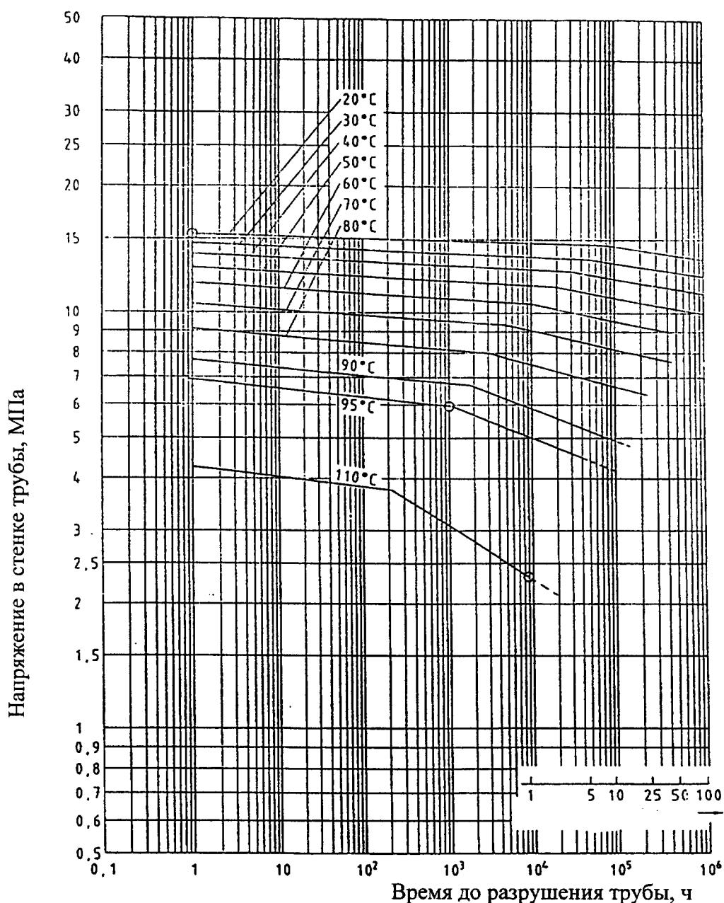
Левая часть ломаной:  $\lg(t) = -430,866 - (125010/T) \cdot \lg(\sigma) + 173892,7/T + 290,0569 \cdot \lg(\sigma)$
