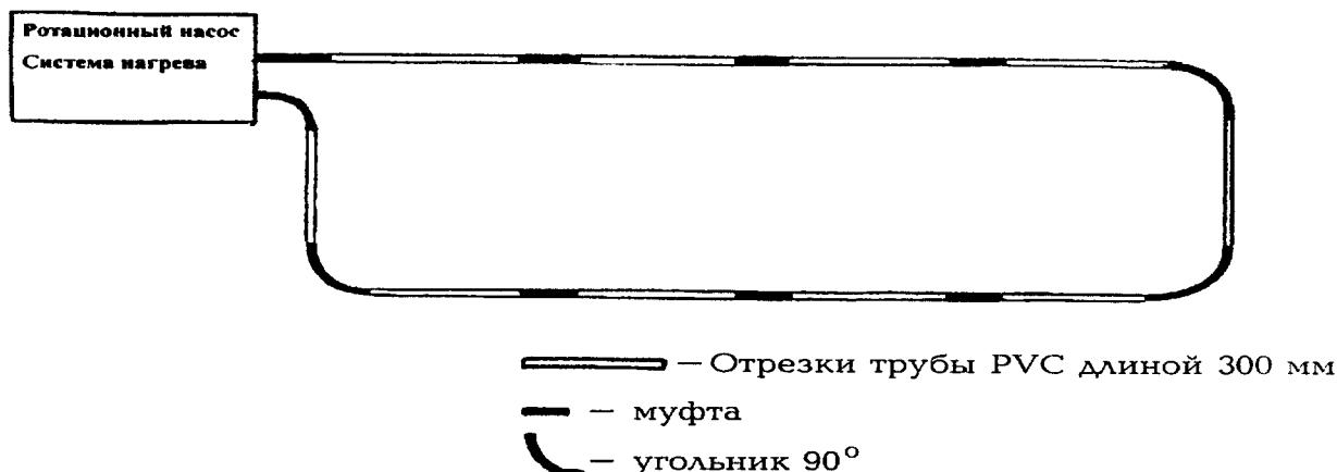
Рисунок 2 – Схема испытаний клеевых соединений труб и фитингов из PVC-С на стойкость к аварийной температуре ( $T_{авар}$ )
