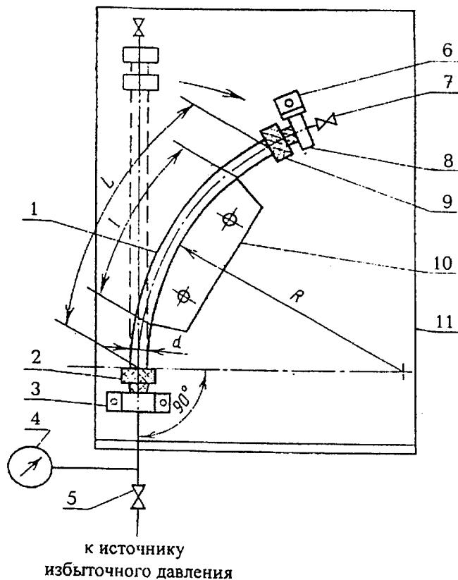
1 - труба; 2 - испытываемый фитинг; 3 - соединительный ниппель; 4 - манометр;
