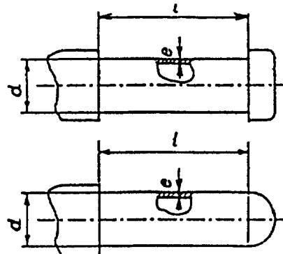
$$\begin{aligned} d &\geq 50 \text{ мм} \\ e \text{ для серий труб } 6,3 &\leq S \leq 10, \\ 1 &\geq 3d \text{ (для } d = 50 \text{ мм } 1 = 140 \text{ мм)} \end{aligned}$$
