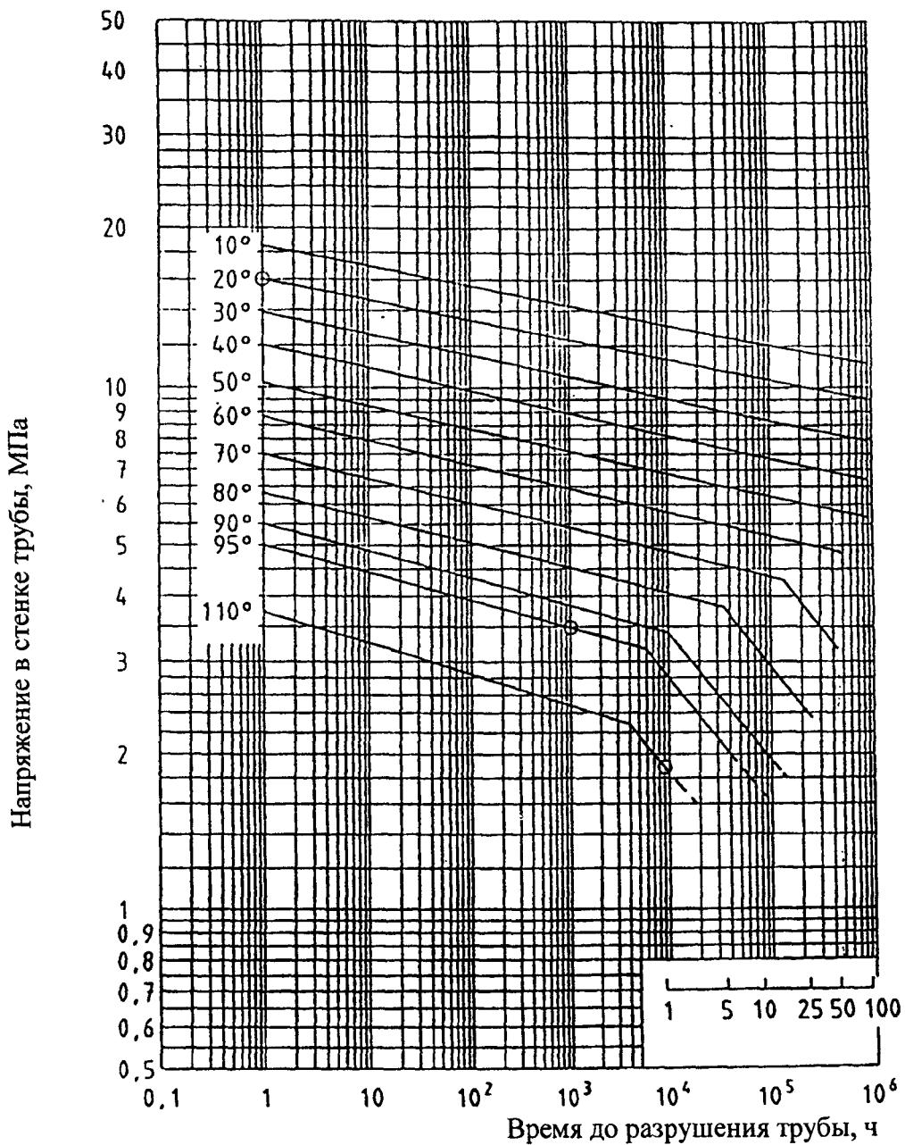
Левая часть ломаной:  $\lg(t) = -55,725 - 9484,1 \cdot \lg(\sigma)/T + 25502,2/T + 6,39 \cdot \lg(\sigma)$
