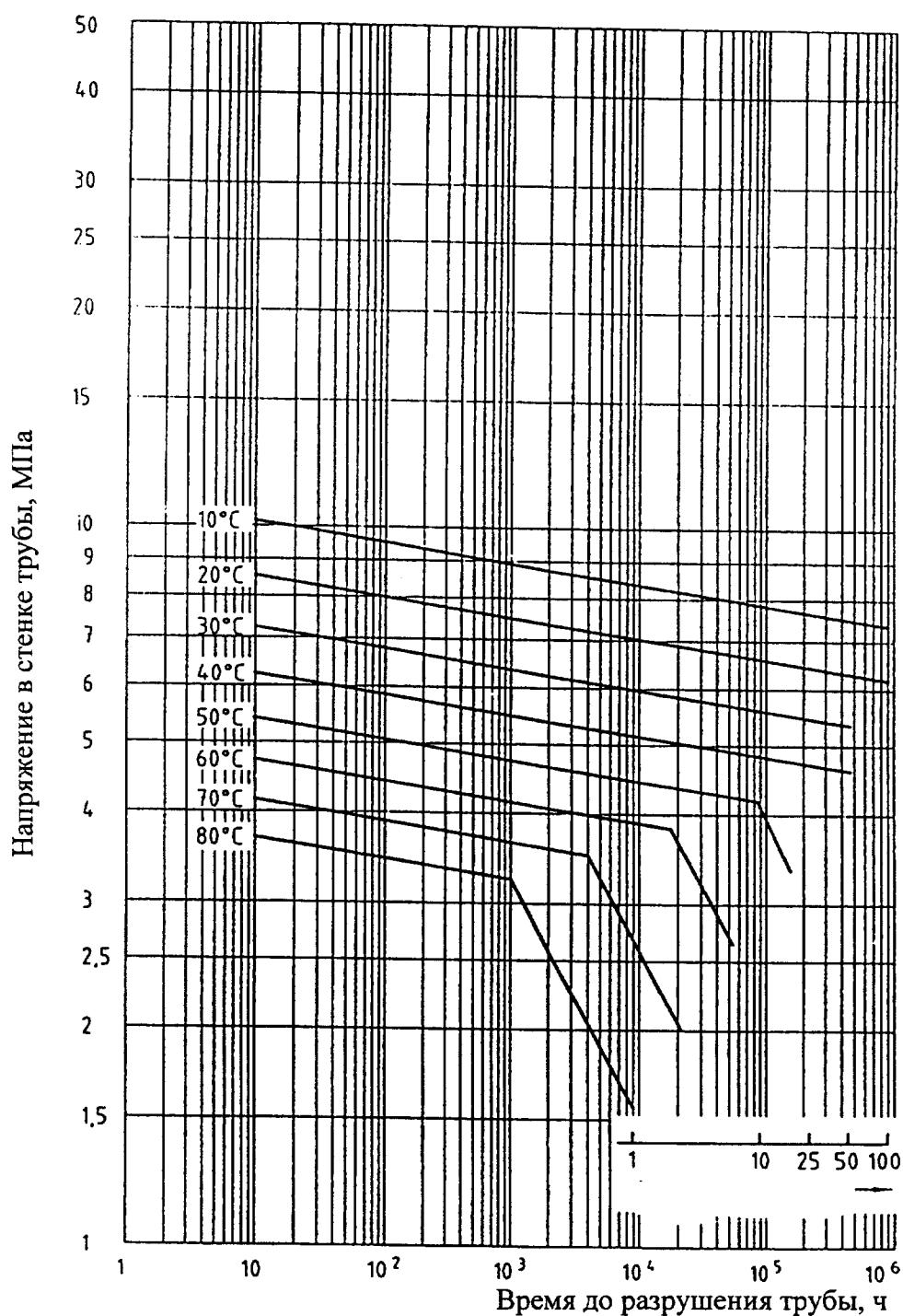
Левая часть ломаной:  $\lg(t) = -41,4173 + 22008,5722/T - 35,0987 \cdot \lg(\sigma)$
