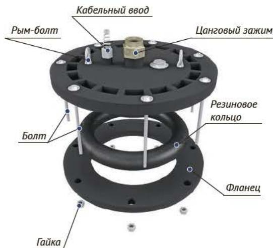
▶ Рис. 1.20. Внутреннее устройство кессона «ПК НИС».
